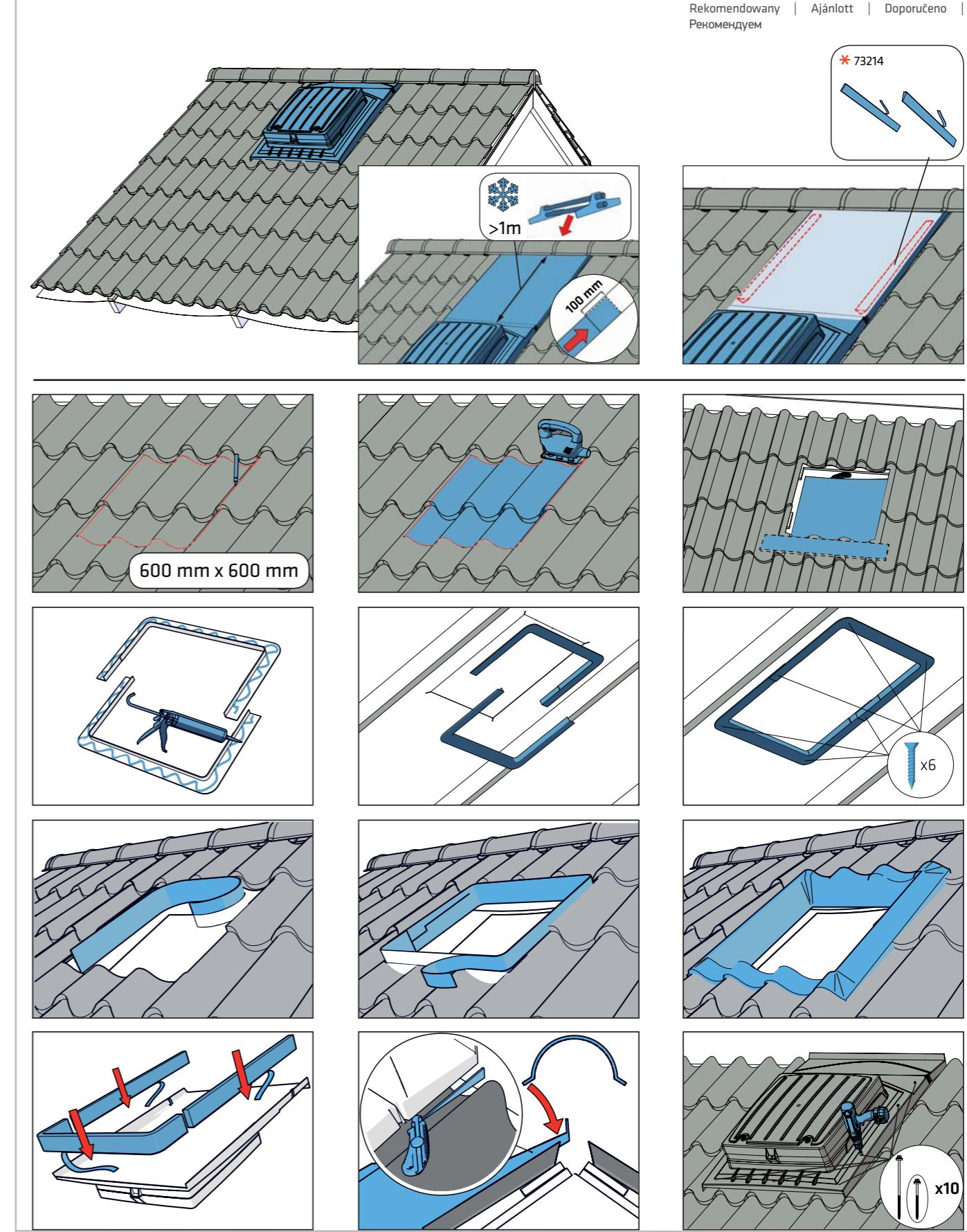
Installation on a tile roof | Asennus tiilikatolle | Installation på panntak | Installation auf einem Ziegeldach | Installatie op een pannendak | Installation sur un toit en tuile | Paigaldamine kivikatusele | Irengimas ant čerpiau stogo | Uzstādīšana uz dakstiņu jumta | Montaż na dachu krytym dachówkami | Beépítés cseréptetőn | Instalace na střechu s taškovou krytinou | Установка на цементно-песчаной и керамической черепице
