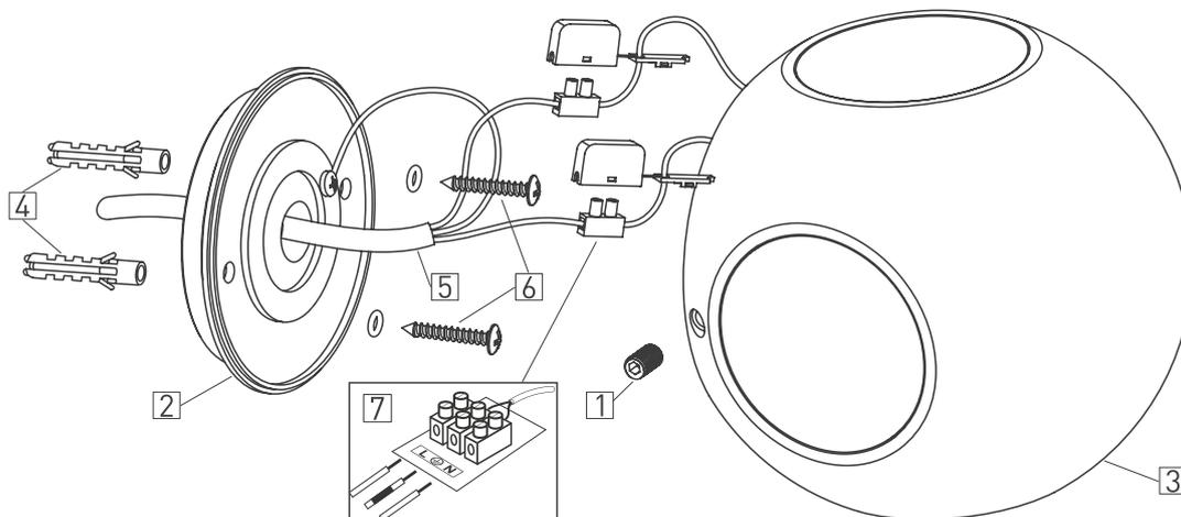
Рис. 1. Установка и подключение светильника.
